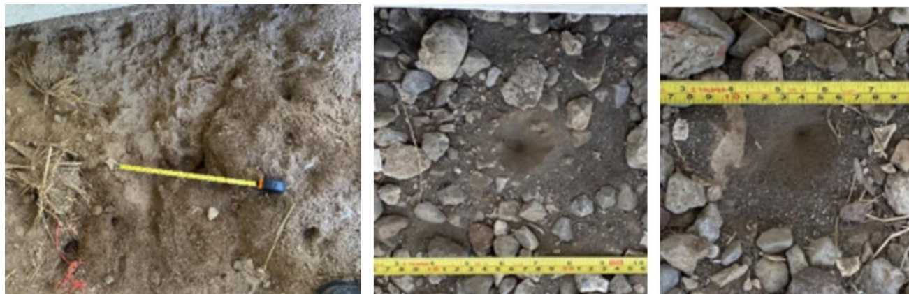
Figura 3.15 Pequeños volcanes generados alrededor del edificio de laboratorios
