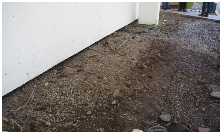
Figura 3.14 Generación de múltiples pequeños volcanes alrededor del laboratorio
