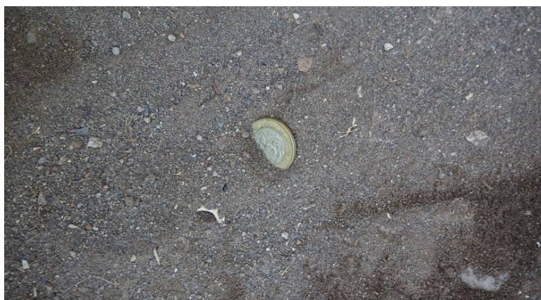
Figura 3.16 Arena con granos de tamaño medio a grueso, que constituye el suelo licuado
